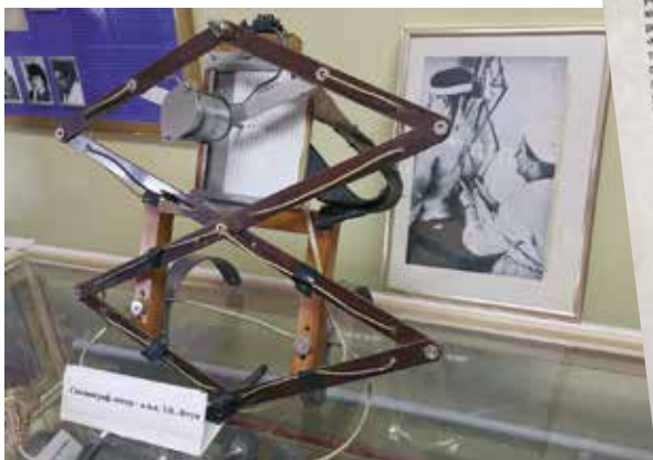
Аппарат для измерения искривления позвоночника, разработка экспериментальной мастерской ИИЦХТ
