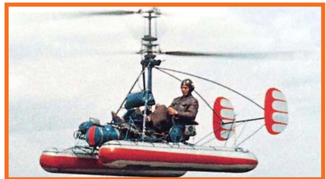
После войны Камов создал двухвинтовые вертолеты — воздушные мотоциклы. На фото Ка-10
