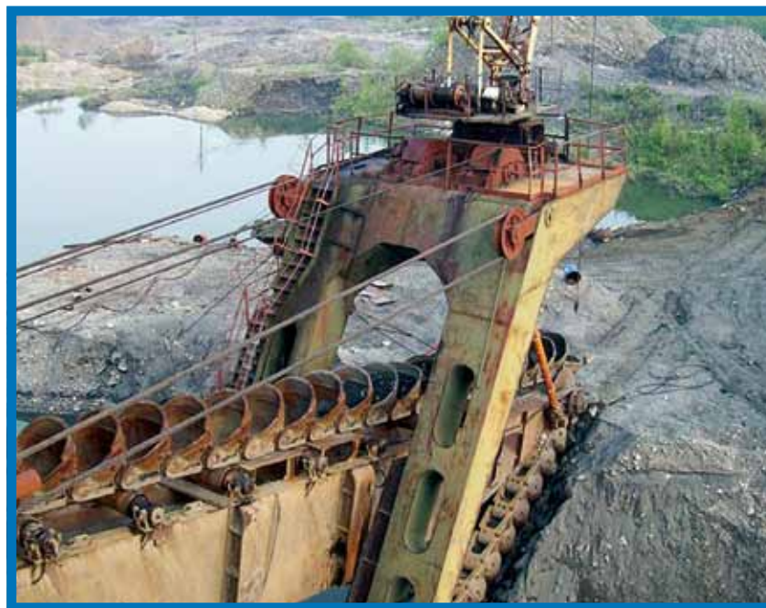
600-литровая драга № 601 проработала на реке Маракан 23 года. 150 черпаков весом по три тонны каждый все это время извлекали из россыпей золото и укладывали шлаки в отвал
